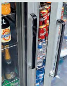
Porte a triplo vetro con profilo in alluminio anodizzato. Dotate di cerniere a molla e guarnizioni magnetiche amovibili per la pulizia. Le porte degli armadi a bassa temperatura sono provviste di resistenze antiappannamento.
